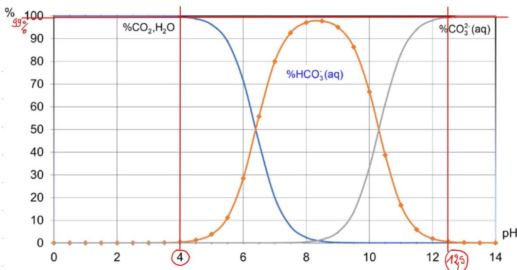
**Q4.** L'alcalinité de l'eau étudiée est due principalement aux ions hydrogénocarbonate  $\text{HCO}_3^-$ .
